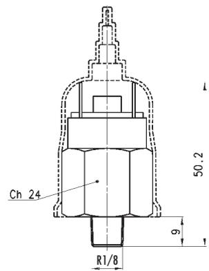
**NC** = Il pressostato apre un contatto elettrico quando si raggiunge la pressione prestabilita.
